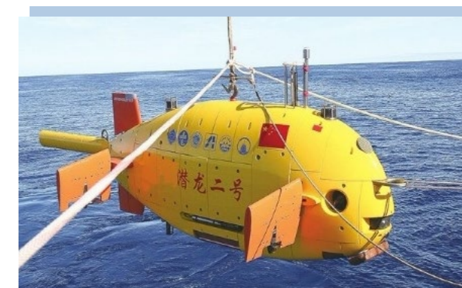
圖 3：自主潛航器 Picture 3: Autonomous Underwater Vehicle (AUV)
