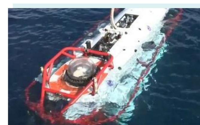
圖 5：LR7 深潛救生艇 Picture 5: LR7 Deep dive lifeboat
